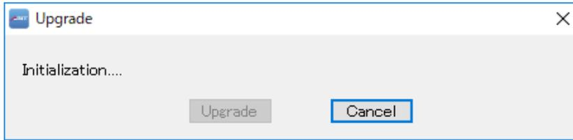
ツールが起動したら「Upgrade」をクリックします。本製品の挿入待ち状態となります。
