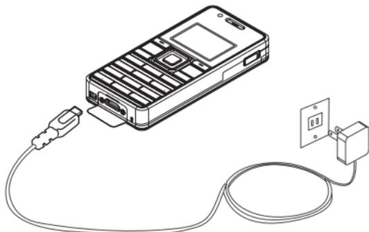
AC アダプタのコネクタを刻印面を上にして本機の USB 端子接続部に接続する
